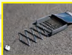
伸張しながら取り出し、ケーブルを引いて展開
